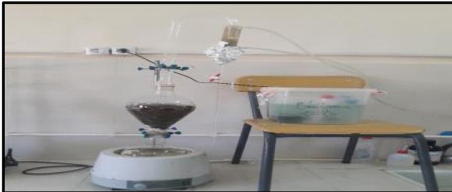
**Figure 15.** Représenter de l'équipement l'entraînement à la vapeur d'eau (Originale, 2024).
