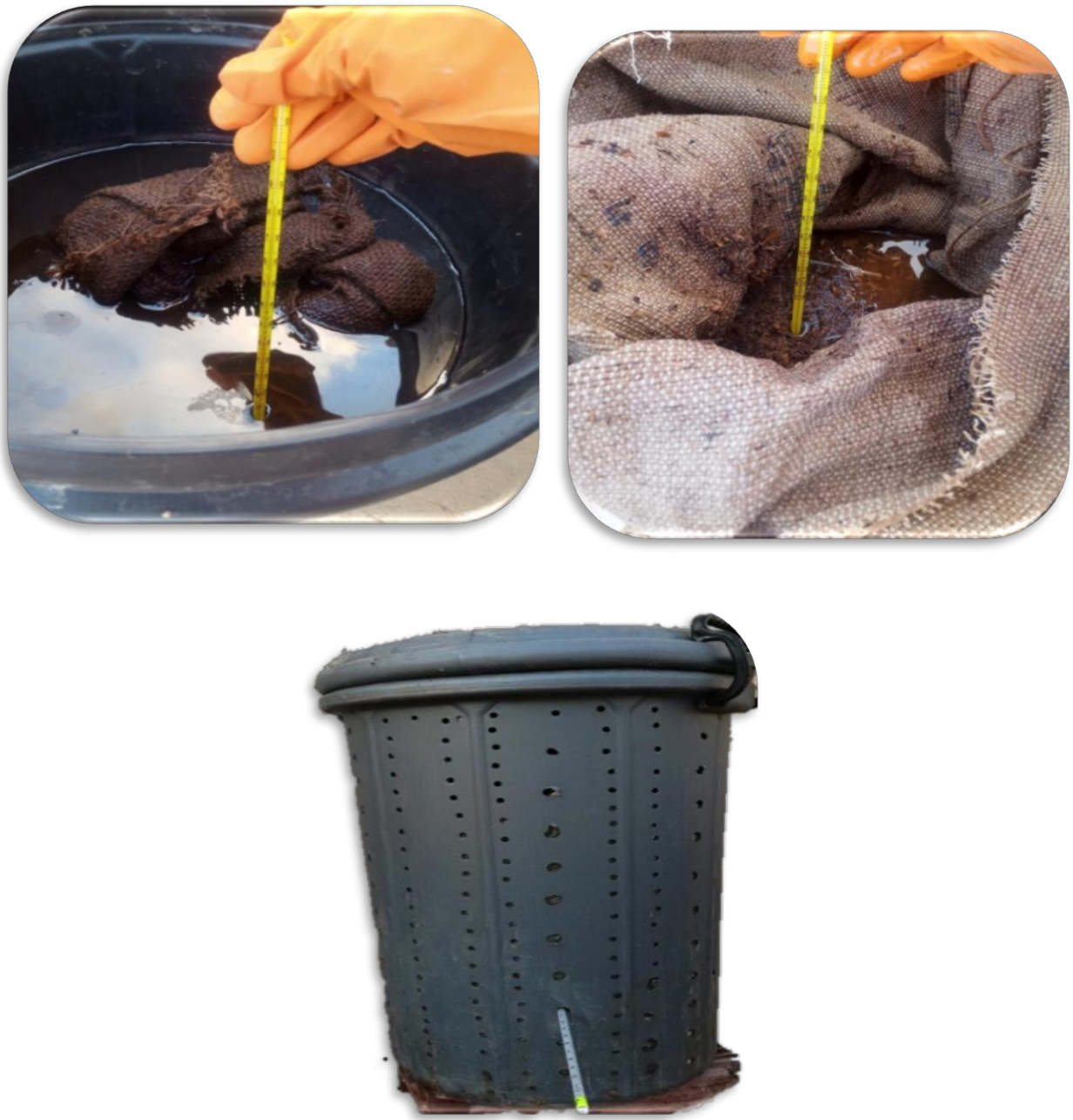
Figure 9. Mesure de la température l'aide d'un thermomètre à mercure (Original).
