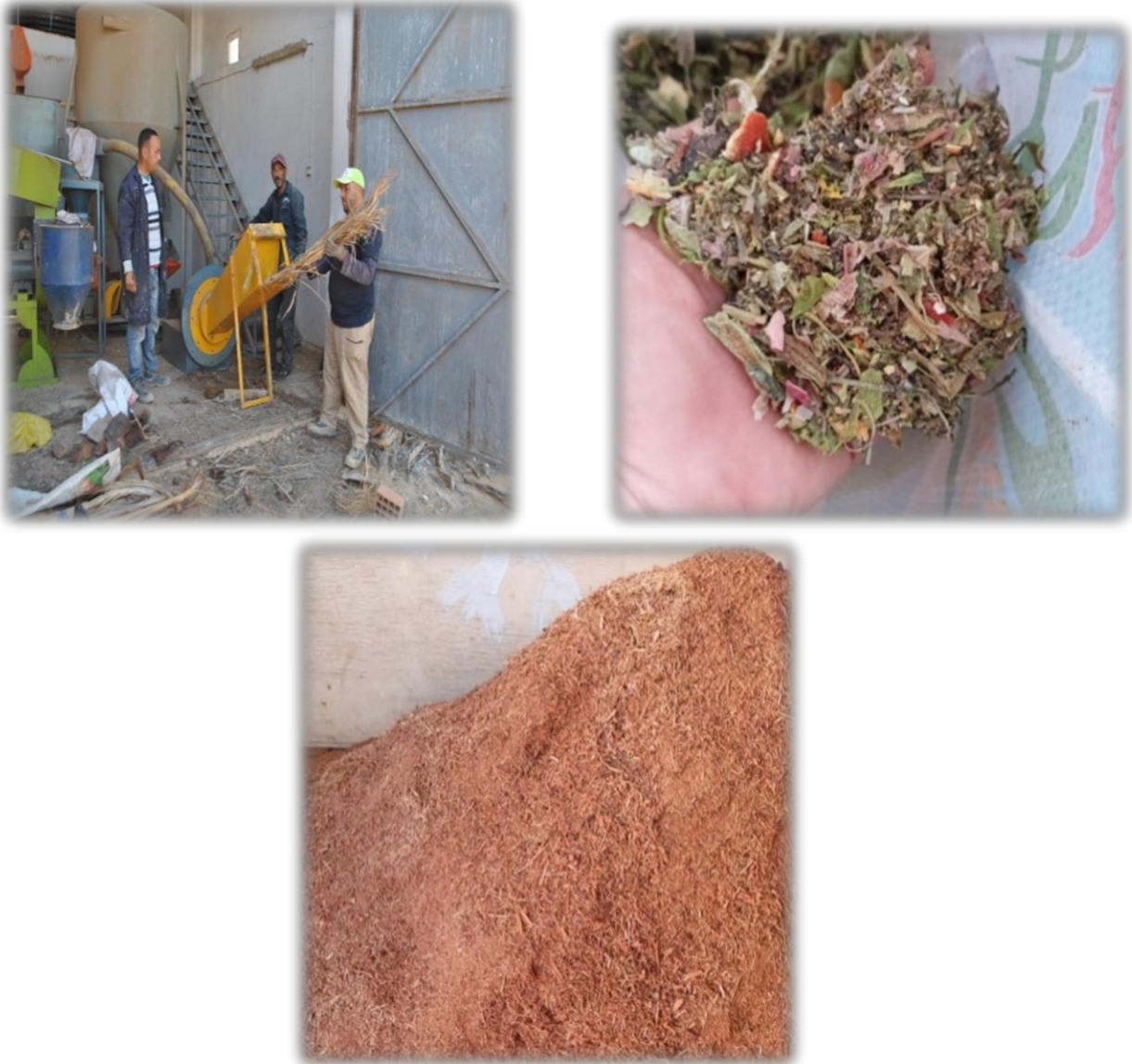
Figure 8. Broyage des matières résiduelles des palmiers dattiers et déchets collectés par un broyeur au niveau du CRSTRA-station El-Outaya –Biskra (Original).
