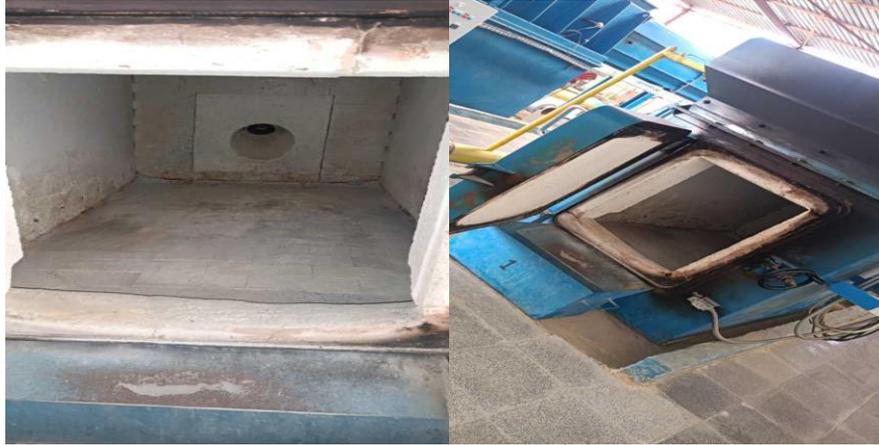
**Figure 22.** La structure internes et externes de l'incinérateur (Original, 2024).
