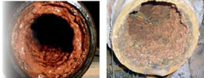
Figure 4.1 : Entartage par dépôt de calcaire.
