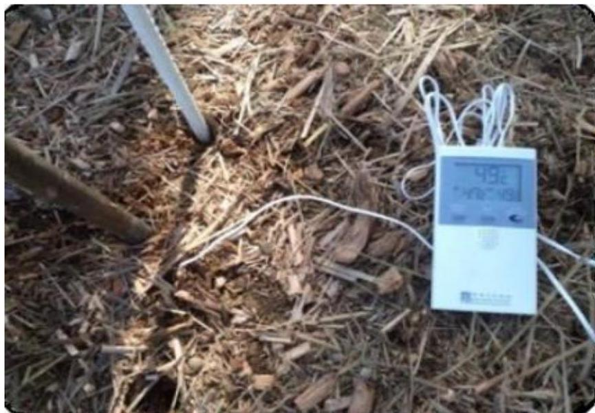
**Figure 10 : Mesure de température dans l'andain (ITDAS).**
