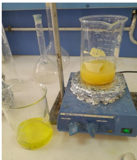
Photo 14 : Dosage de chlorure (photo originale)
