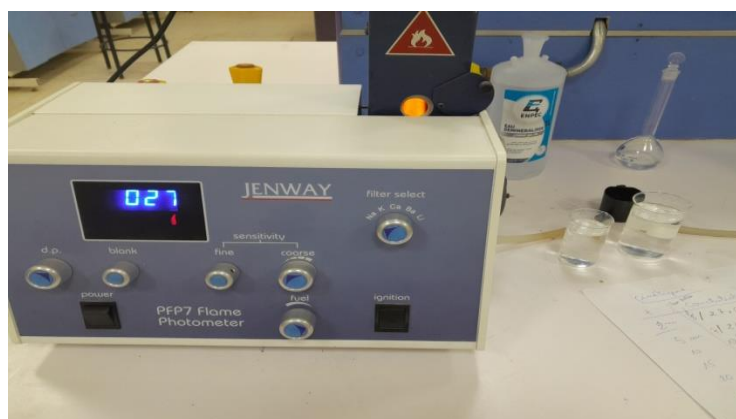
Photo 9 : dosage Na + et potassium de sol (photo originale)
