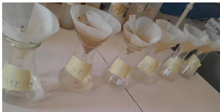
Photo 6 : l'extrait du sol après la filtration (photo originale)
