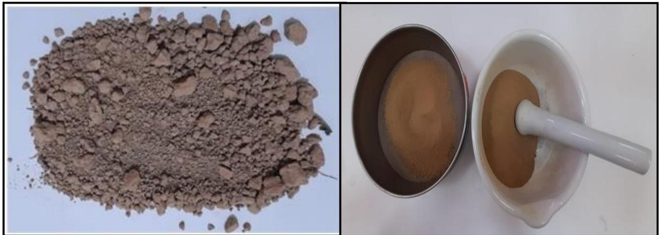
**Figure 09:** Séchage, broyage et tamisage du sol (Photo originale)
