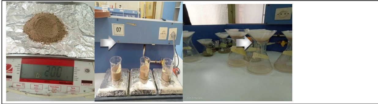
Figure 10 : Extraction des sels par l'eau distillée
