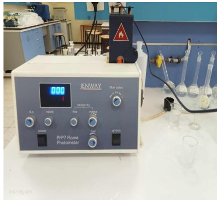
Figure 13: dosage de K^+ et Na^+ par photomètre à flamme type JUNWAY PFP (photo originale).
