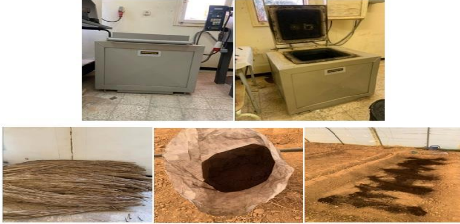
الشكل 9: الأداة المستخدمة في تحضير الفحم الحيوي وطريقة توصيله إلى قطع الاختبار.
