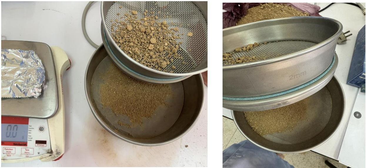
Photos11: préparation des échantillons du sol
