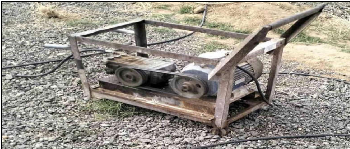
Figure(10) : système d'alimentation en oxygène des bassins
