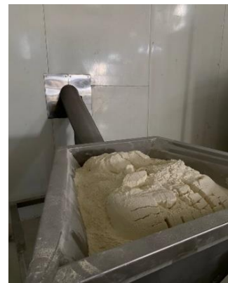
Figure 57: une machine spécial pour tirer la farine dans le mélangeur
