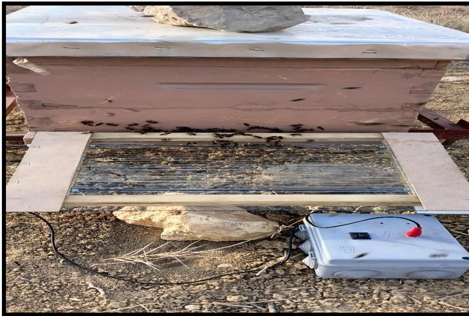
Figure 33: Essai le collecteur du venin (Saci ,2024)
