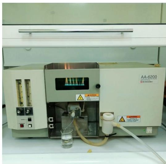
**Figure 16: spectrophotomètre d'absorption atomique**
