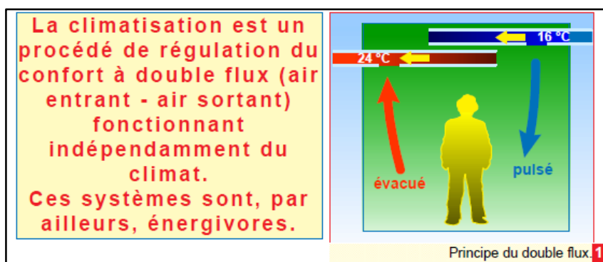
Figure 70 : principe du double flux.
