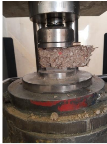
الشكل 3-17 العينة الموضوعة على مكبس هيدروليكي (اختبر الضغط).
