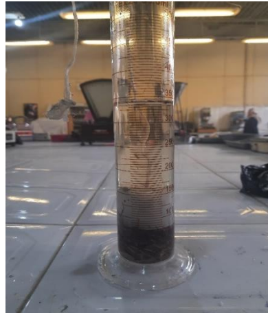
الشكل 3-6 تجربة قياس الكتلة الحجمية المطلقة.
