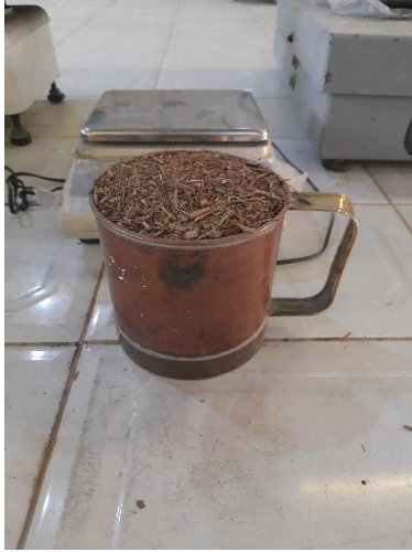
الشكل 3-5 قياس الكتلة الحجمية الظاهرية.
