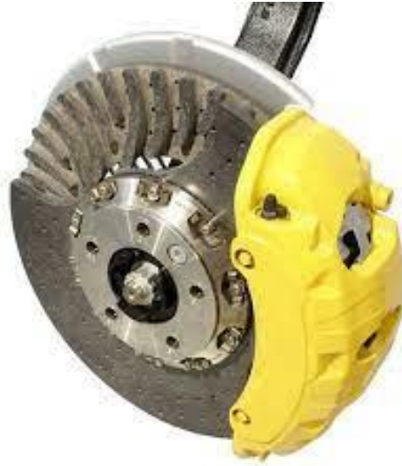
الشكل 1-24 أقراص الفرامل المصنوعة من السيراميك.
