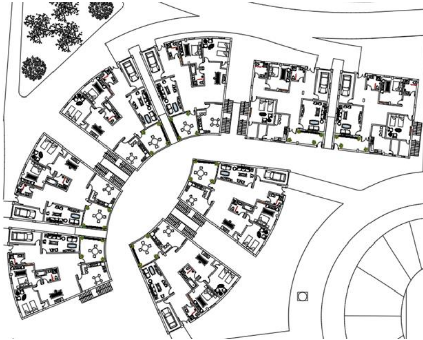
الشكل 4-12: المخطط الأرضي للتجميعية السلم 200/1 المصدر: الباحثة
