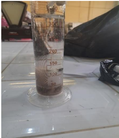
الشكل 3-6 تجربة قياس الكتلة الحجمية المطلقة.
