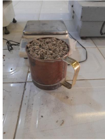
الشكل 3-5 قياس الكتلة الحجمية الظاهرية.
