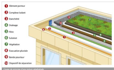
الصورة 8: صورة توضيحية لطبقات الأسطح الخضراء
