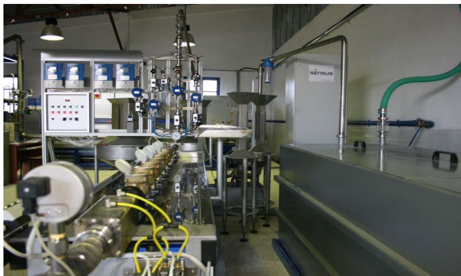
Figure III.6 : Déshydratation des boues Source : (le site internet de la société de l'eau et de l'assainissement de Constantine°)
