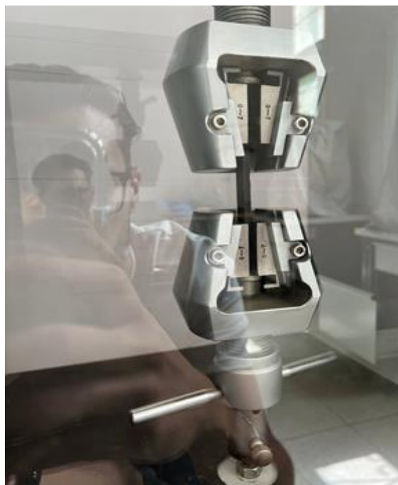
Figure IV.2: Test de traction du plastiques recyclé
