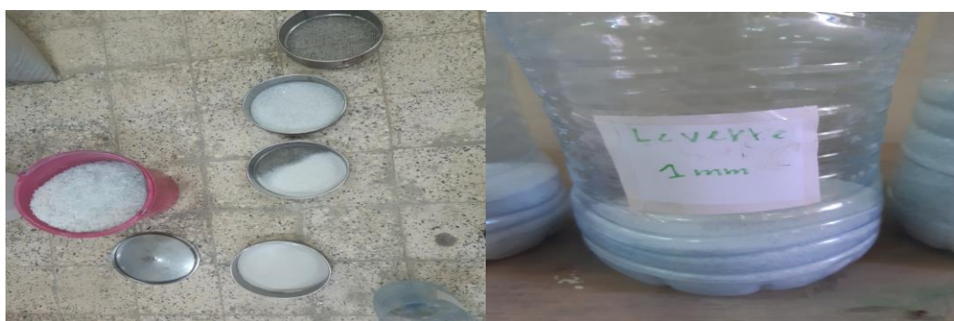
Figure III.19: Le verre obtenu après le processus d'analyse granulométrique
