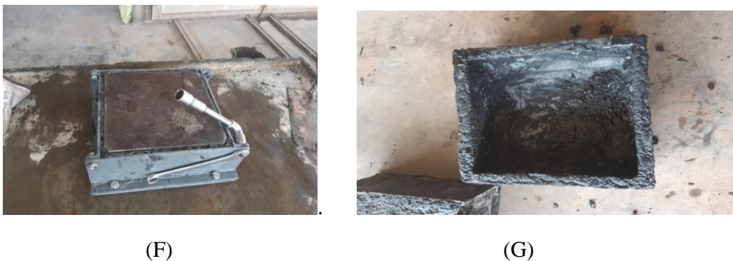
FigureIII.18 : Photographies numériques montrant (F):Démoulage le moule avec des clés . (G): boîte en plastique
