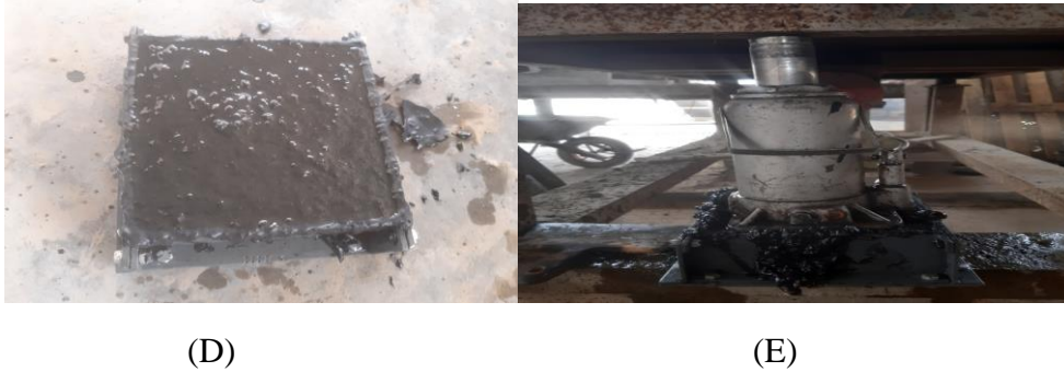
FigureIII.17 : Photographies numériques montrant ( D ) : Moulage de mélange dans le moule . ( E ) : compression par cric hydraulique
