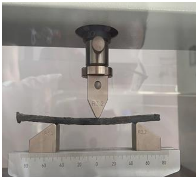
Figure IV.4: Test de flexion trois points du plastique recyclé
