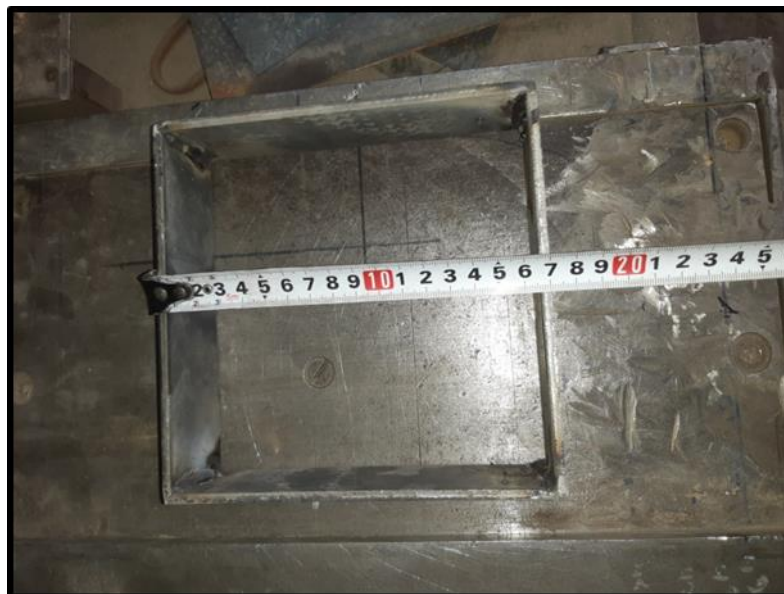
FigureIII.7 : Photographie numérique montrant la réalisation de la forme cubique par soudure
