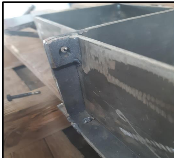
FigureIII.6 : Photographie numérique montrant le fer plat soudé dans le côté de moule
