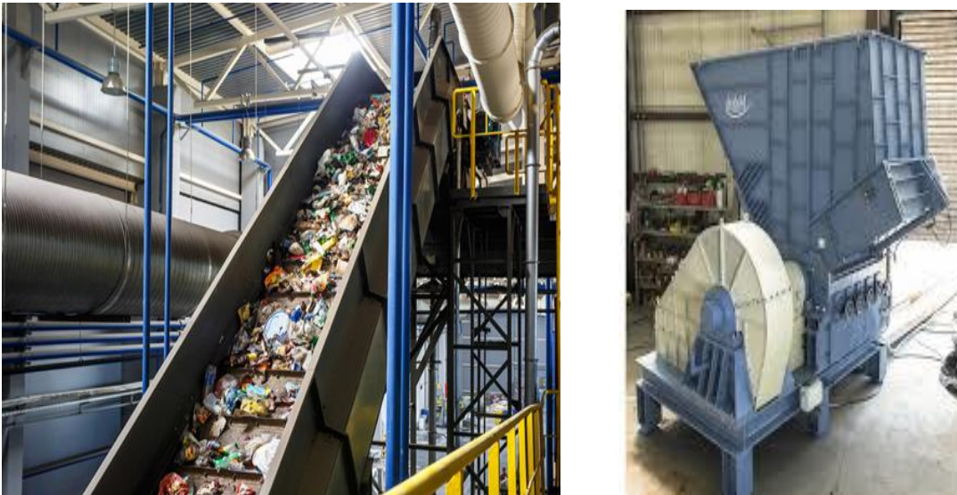
Figure II.5: Broyage plastique et lavage des déchets plastiques
