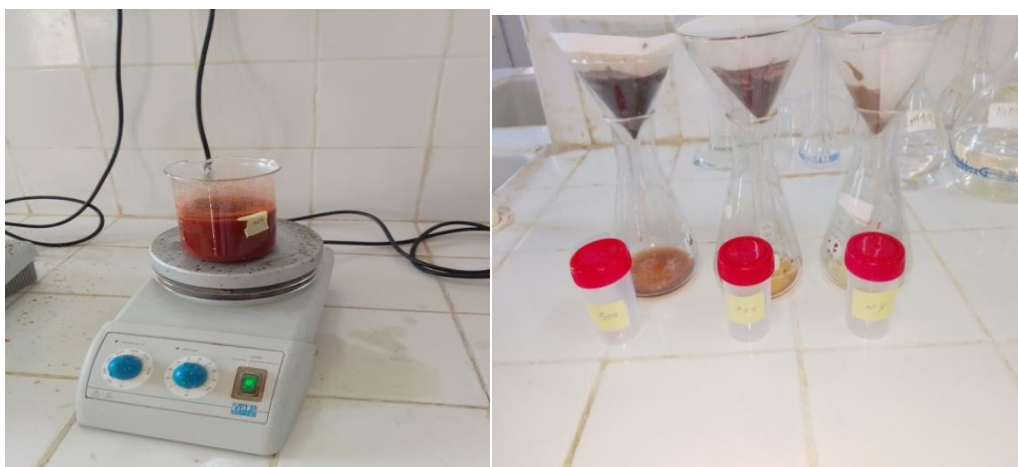
Figure I.2 : Activation du broyât des noyaux de dattes
