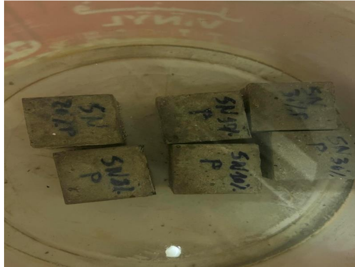
الشكل 10.3. II. تمثل تجربة الامتصاص بالغمر
