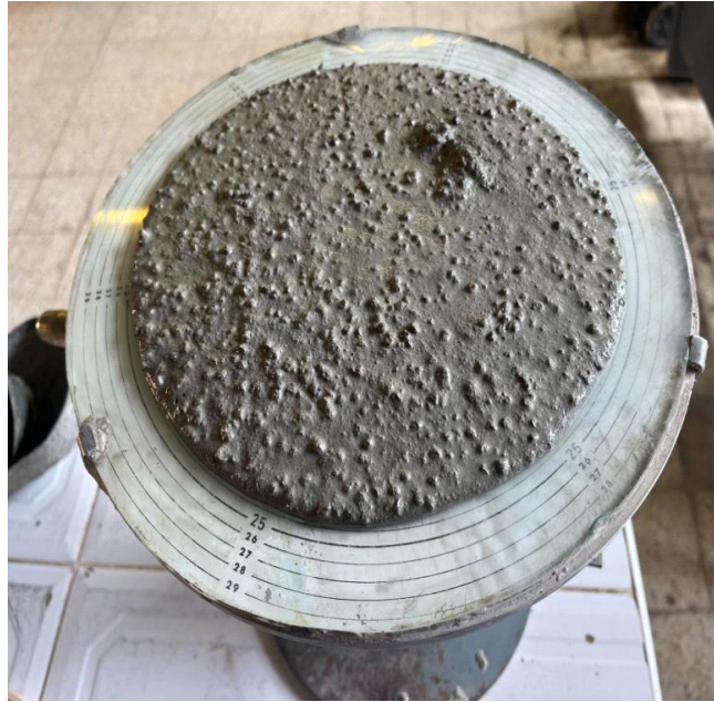
الشكل 9.3. II. تمثل تجربة السيولة
