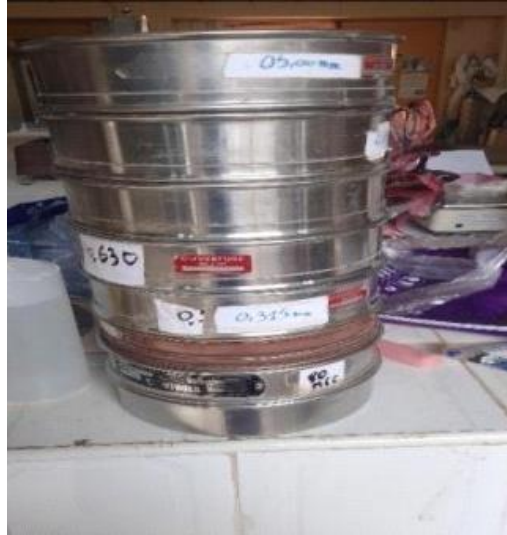
الشكل 4.2. II. تمثل الغرابيل المستعملة لتحليل الحبيبي
