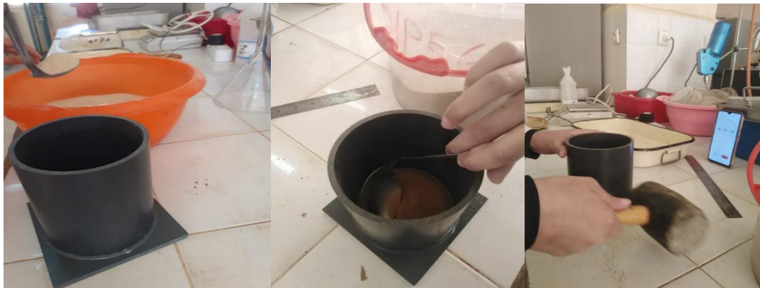
Figure 2.9. : Préparation l'indice de densité minimal, a) l'échantillon est prélevé , b) versement d'une petite quantité pour former une couche, c) compactage et vibration
