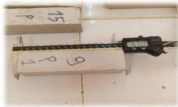
Figure 2.23. La mesure des dimensions à l'aide de pied à coulisse électronique.
