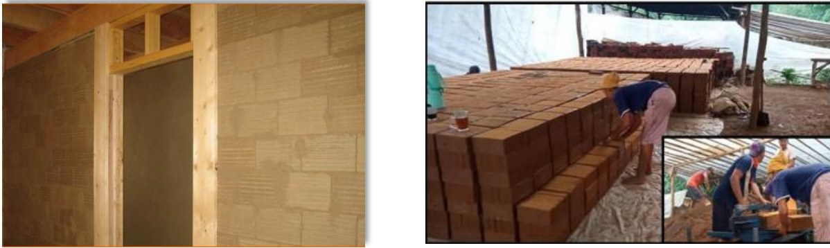
Figure 1.8. La brique de terre extrudée (ou filée) (Pascal Maillard, 2013), fabrication des blocs de Terre extrudée (source : https://youtu.be/sQaXOxe9O1I ).
