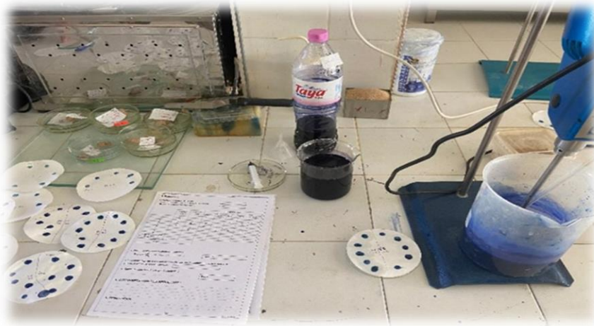
Figure 2.8. Agitation mécanique de la suspension de sol et les taches de bleu de méthylène sur le papier filtre.
