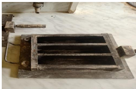
Figure 2.18. Le moule utilisé pour le moulage et la confection des éprouvettes de mortier de terre.
