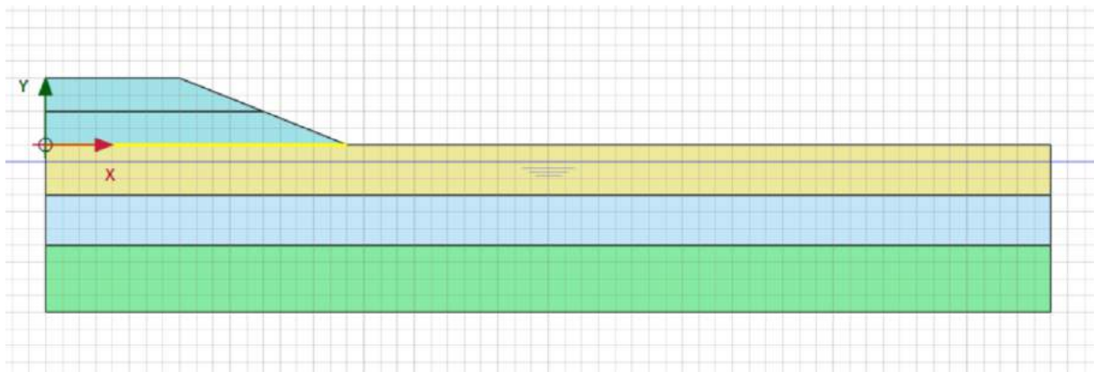
Figure IV.6 : Géométrie du problème renforcé avec géosynthétiques
