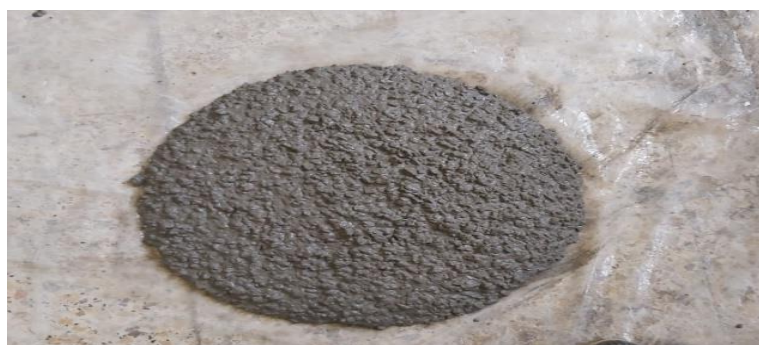
Photo 2-3 : Essai d'étalement au cône d'Abrams (slump flow).
