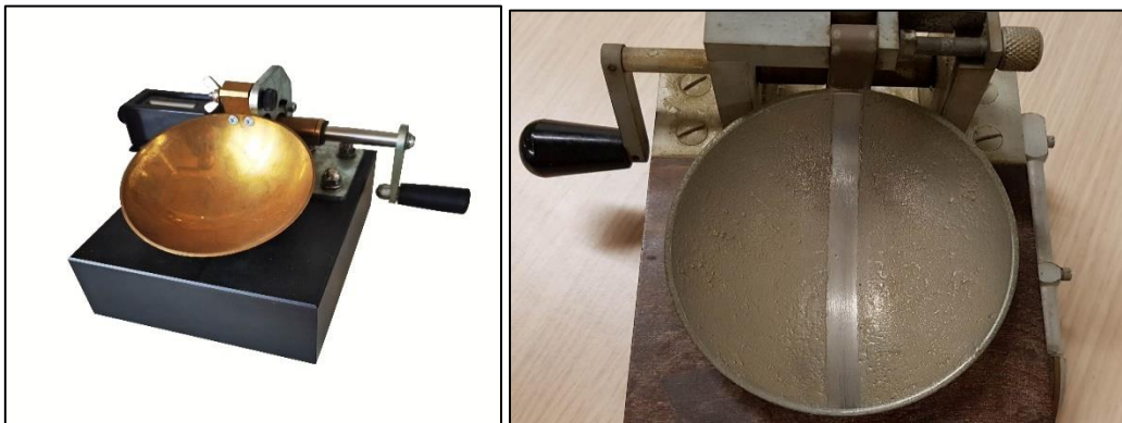
Figure. VII.2. L'appareil de cassagnarde
