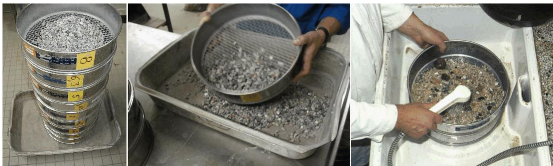
Figure. VII.1 : les phases de l'essai analyse granulométrique
