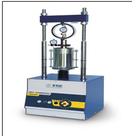
Figure. VII .5 : L'appareil L'essai CBR
