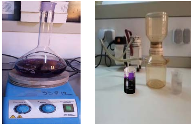
Figure 10 : Cinétique d'adsorption du CV sur le CAC et la Pompe de filtration sous vide.
