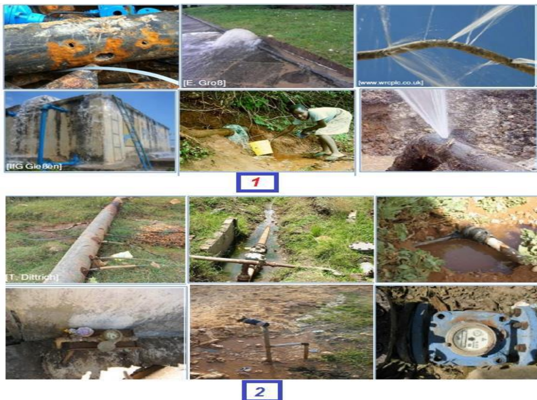
Figure 10 : les pertes d'eau (1 : pertes physiques ; 2 : Pertes apparentes)
