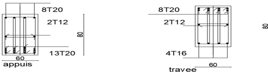
Figure VI.10. Schéma de ferrailage de la nervure en travée et en appui
