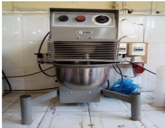
Figure II. 7 Malaxeur à mortier
