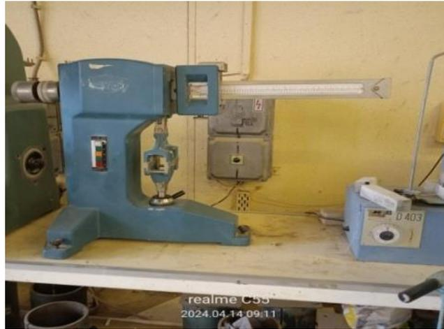
Figure II.5 :Appareil de traction par flexion.
