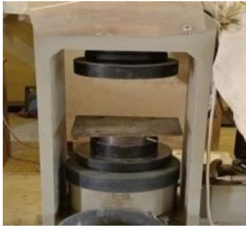
Figure II.4 : Appareil d'essai de compression
