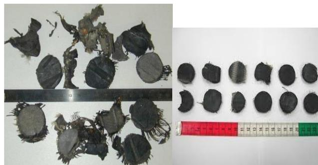
Figure I.11 Coupeaux de pneus déchiquetés.
