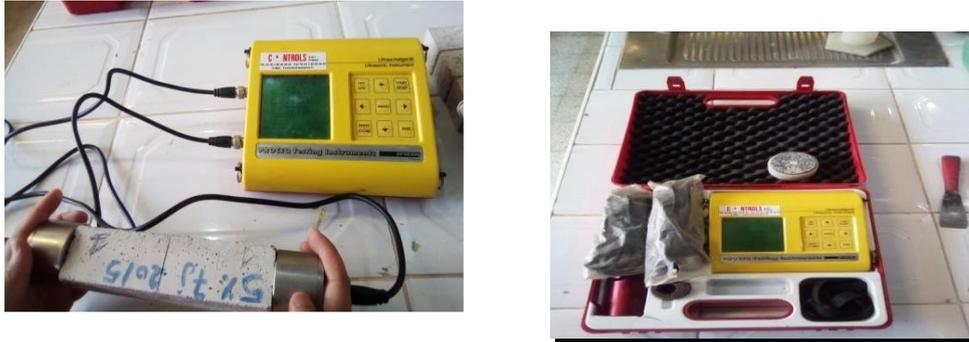
Figure II.6 : Instrument de mesure la vitesse du son dans le béton
