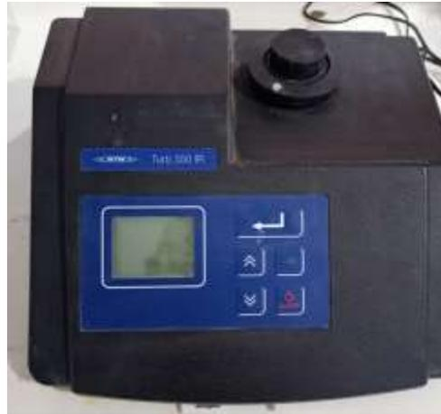
**Figure 19 :** Turbidimètre (Turb 550IR) utilisé pour la détermination de la turbidité des échantillons.
