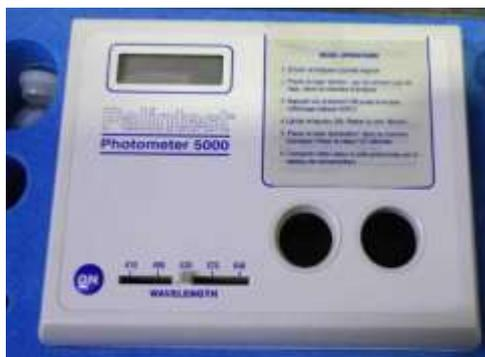
**Figure 18 :** PALINTEST 5000 utilisé pour le dosage des ions de sulfates.
