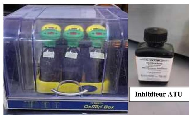
**Figure 20 :** Appareillage utilisé pour la mesure de la DBO<sub>5</sub>
