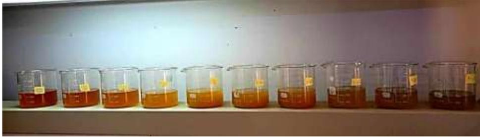
**Figure 29 :** Couleur des échantillons d'eau traitée après ajout des doses variables du  $\text{FeCl}_3$
