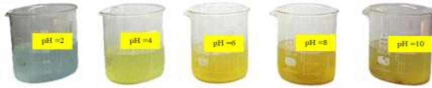
**Figure 32 :** Couleurs des échantillons traités avec 100 mg/L de  $\text{FeCl}_3$  en fonction du pH initial de la solution.
