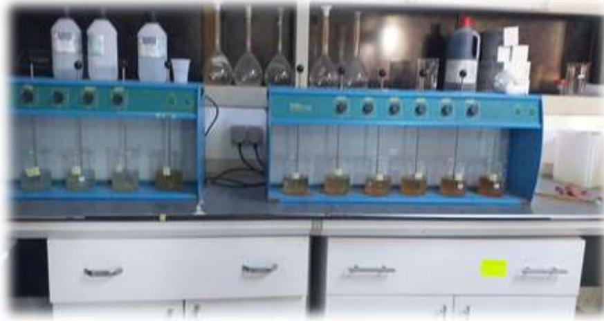
**Figure 24** : Floculateur utilisé pour les essais de coagulation-floculation.
