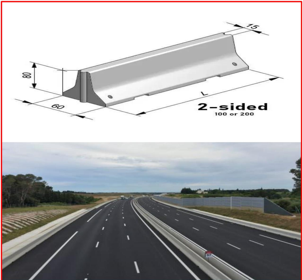
Figure X. 9 : Type séparateur en béton
