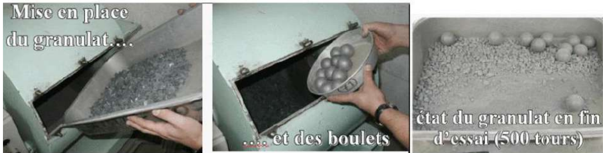
Figure 6-15 : L'essai de LOS ANGELOS CI-DESSOUS
