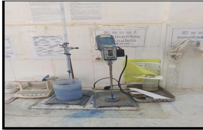
Photo n° 10: matériels de l'essai bleu méthylène
