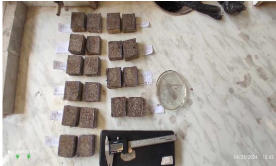
الشكل 16.3: المقطع العرضي للعينة بعد اختبار نترات الفضة.
