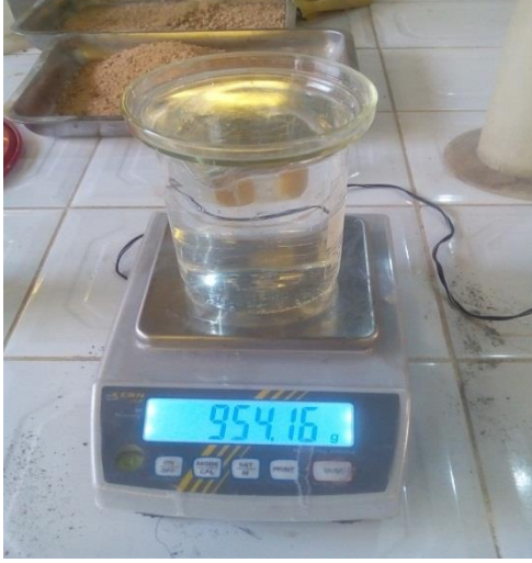
الشكل 13.3: الكتلة الحجمية المطلقة للأكياس البلاستيكية (باستعمال طريقة البالون).
