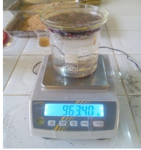
الشكل 13.3: الكتلة الحجمية المطلقة للأكياس البلاستيكية (باستعمال طريقة البالون).
