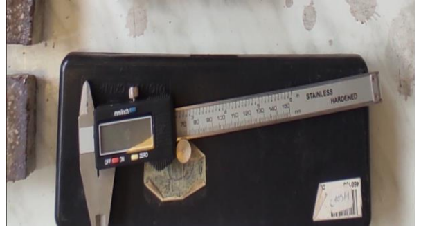
الشكل 16.3: المقطع العرضي للعينة بعد اختبار نترات الفضة.
