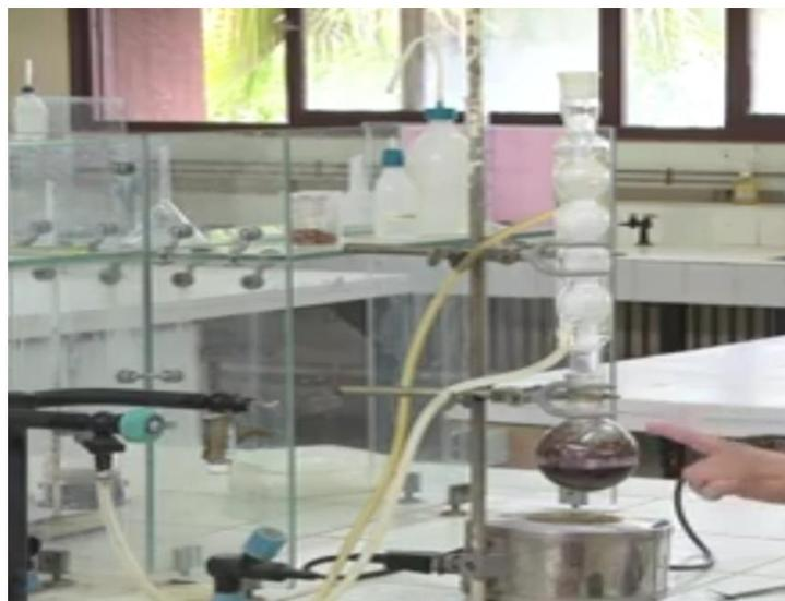
**Figure 5** : la préparation de l'acide benzoïque par le montage à reflux
