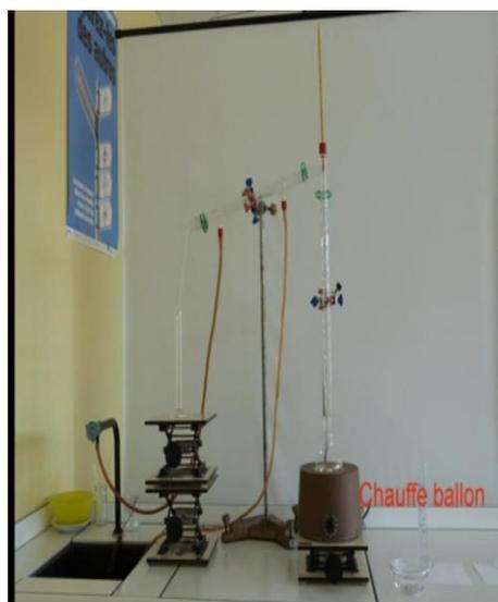
**Figure 10 :** La purification du produit fini par distillation fractionnée
