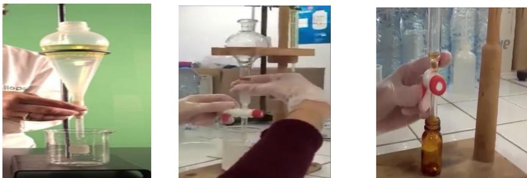
**Figure 12** : Decantation et separation des deux phases
