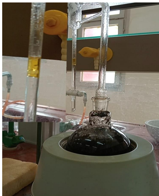
الشكل 18: صورة جهاز كلنجر المستخدم لاستخلاص الزيت الأساسي.
