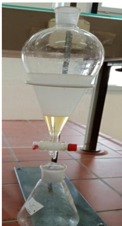
الشكل 20: صورة لفصل الطور العضوي على الطور المائي بأنبوبية الفصل.
