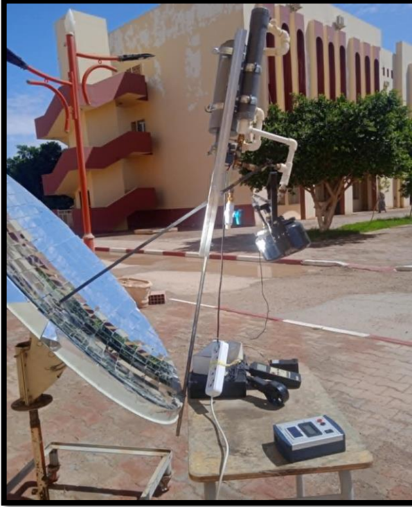
الشكل III.20: التركيب التجريبي الأولي لاستخلاص الزيوت الأساسية بالطاقة الشمسية
