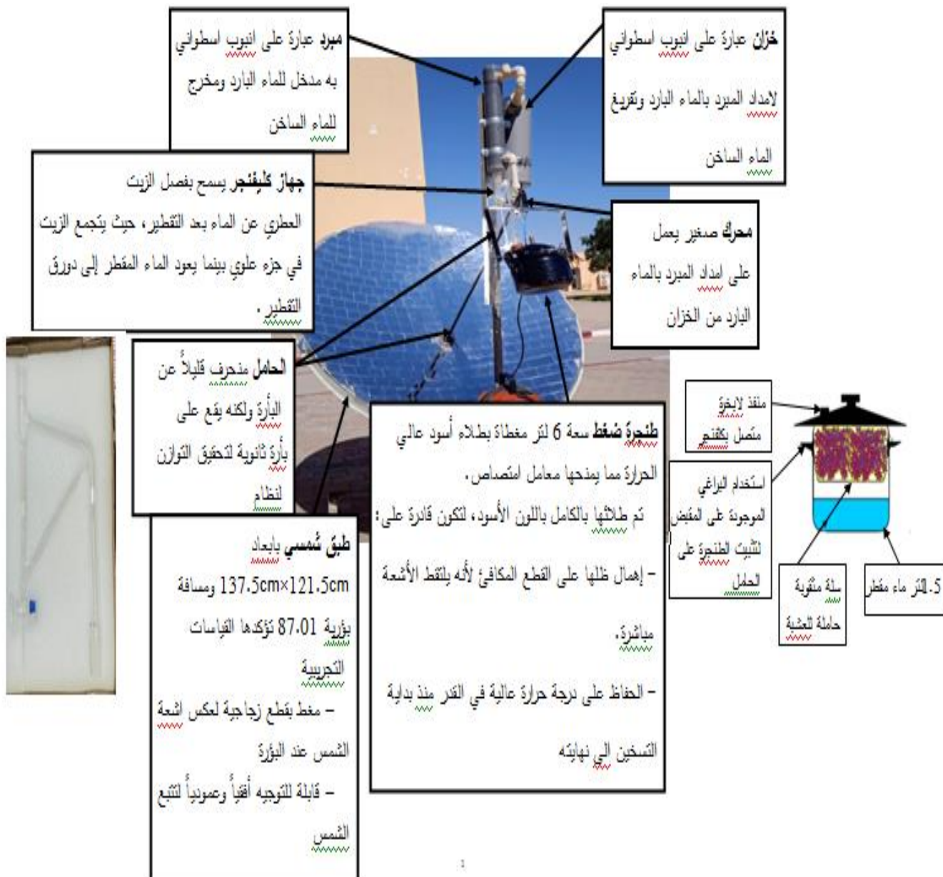
الشكل III.23: صورة للمقطر توضح بيانات كل جزء من المقطر
