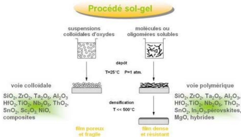
Figure II.4: schéma représente Les deux voies de synthèse dans le procédé sol-gel.
