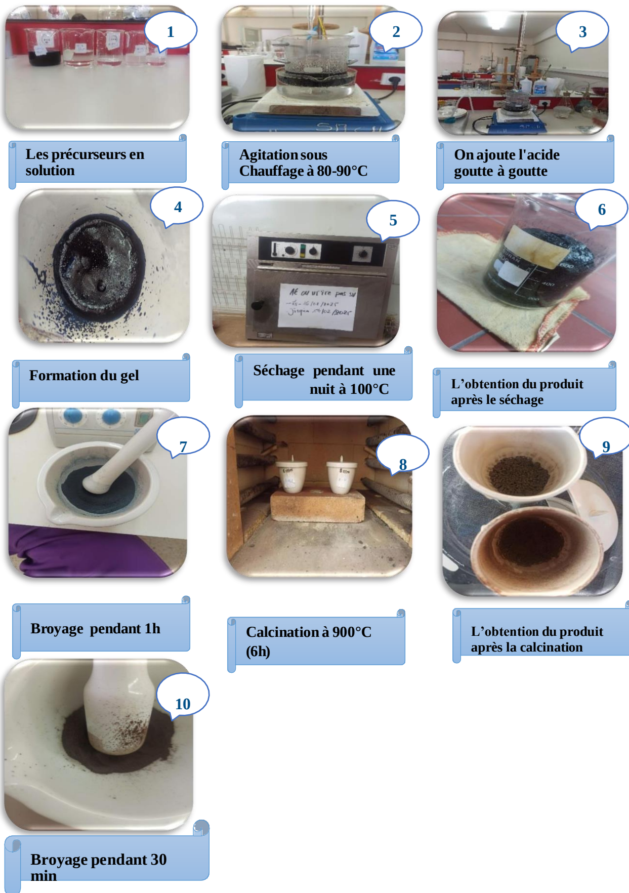
Figure III.1: Les étapes de préparation des précurseurs
