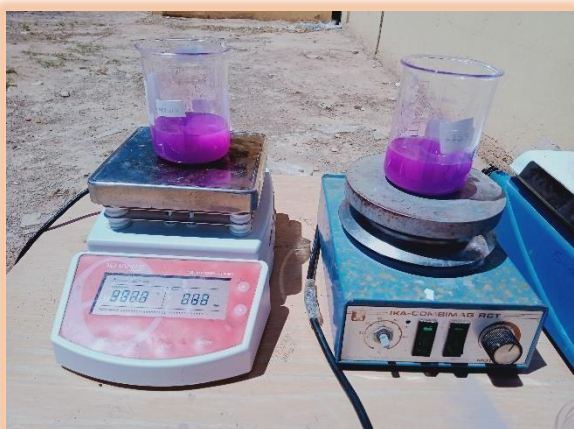
Figure III.10: a) Dispositif expérimental utilisé lors des essais de dégradation photocatalytique du GV sous irradiations solaires.
