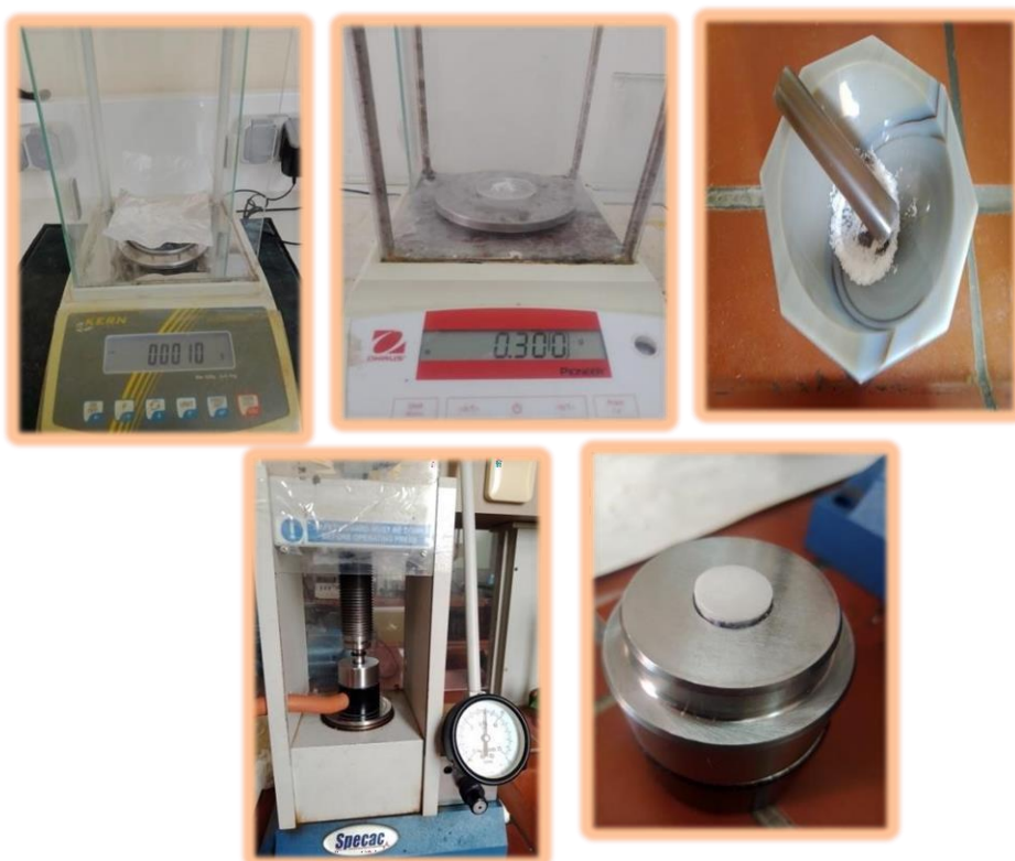
Figure II.10: Préparation d'échantillons pour l'analyse IR.
