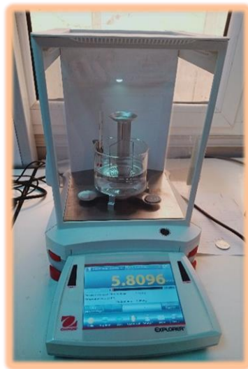
Figure II.5: Balance électrique couplée à l'instrument basé sur la technique de poussée d'Archimède.
