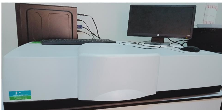
Figure II.12 : Un spectromètre UV-Visible-NIR de type Perkin Elmer Lambda 950
