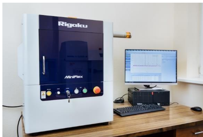
Figure II.8 : Diffractomètre Miniflex 600 en configuration (Bragg-Brentano) dite « \theta - \theta ».
