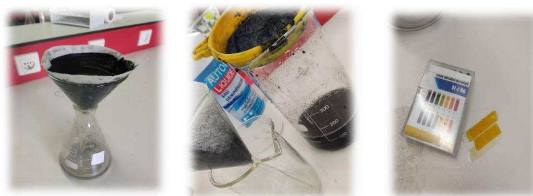
Figure. II. 9. Le charbon actif après la pyrolyse, lavage et filtration.
