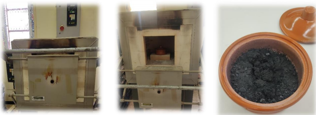
Figure.II. 8. Calcination des grènes CA1 dans le four moufle .
