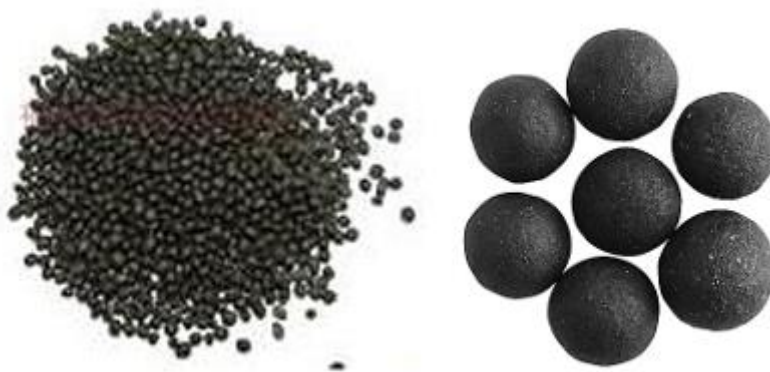
Figure. I.13. Charbon Actif sous Forme Sphérique (CAS).
