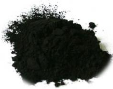
Figure. I. 11. Le Charbon actif sous Forme Poudre (CAP).
