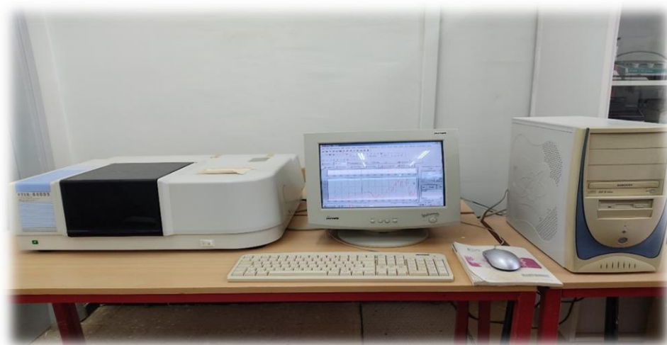
Figure. I. 14. Spectrophotomètre à Transformé de Fourier (FTIR) de Marque SHIMADZU FTIR-8400S.
