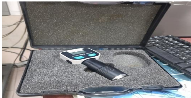
Figure.III .9: Duromètre Shore A
