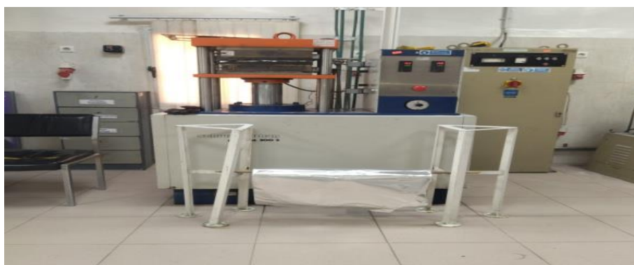
Figure.III .5: Une presse hydraulique Schwabenthanpolystat 300 S
