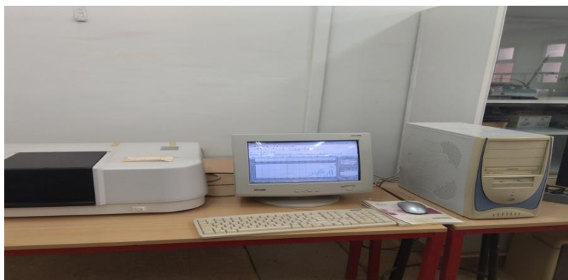
Figure.III .14: Spectrophotomètre à transformée de Fourier de type SHIMADZU FTIR- 8400S(Université de BISKRA)
