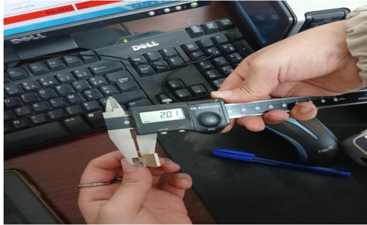
Figure.III .8: Mesure des dimensions de l'éprouvette
