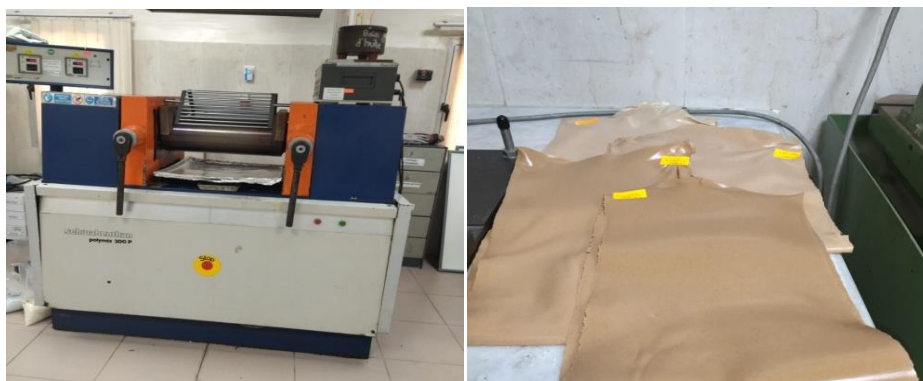
Figure.III .4: Calandre SCHWABENTHAN de type «polymix 200P»
