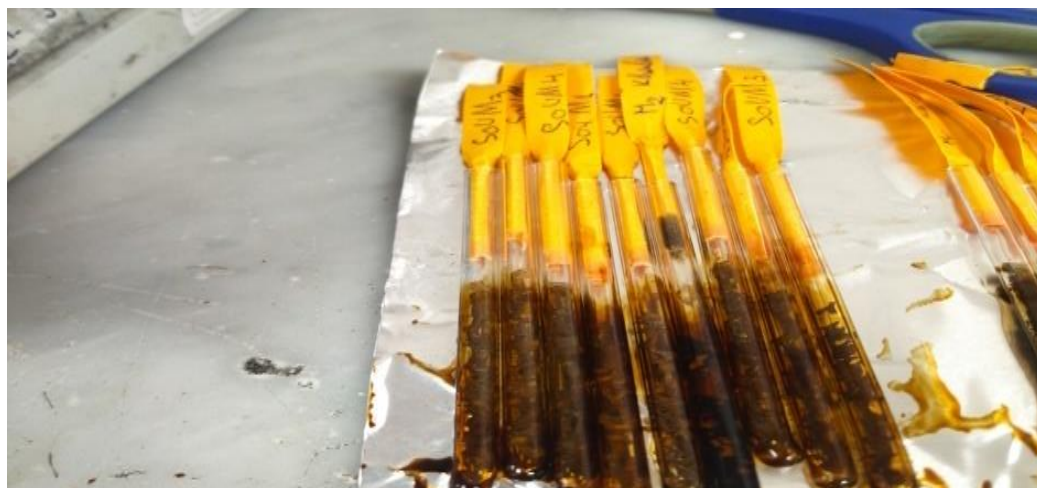
Figure.III .11: Préparation des tubes pour l'essai de stabilité thermique
