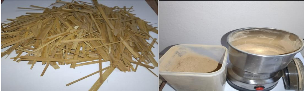
Figure.III .2: Les étapes de préparation de la poudre de fibre DPLF
