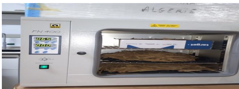
Figure.III .1 :DPLF séchée dans l'étuve à 65°C pendant 3h
