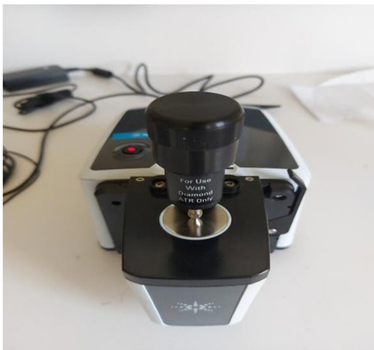
Figure II.11 Spectromètre infrarouge (IRTF) de type Perkin Elmer FT-IR Spectrum Two II.6.Spectrophotométrie Ultraviolet-Visible (UV-Visible)
