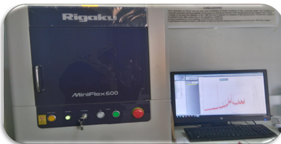
Figure. II.6: Diffractomètre Miniflex 600 en configuration Bragg/Brentano dite ( \theta - \theta ).
