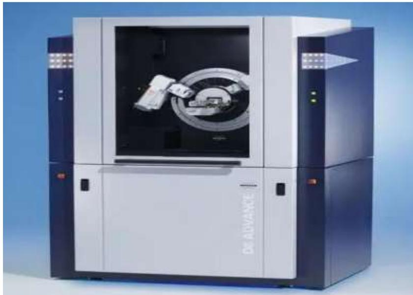
**Figure II.4:** diffractomètre Bruker D8 Advance.
