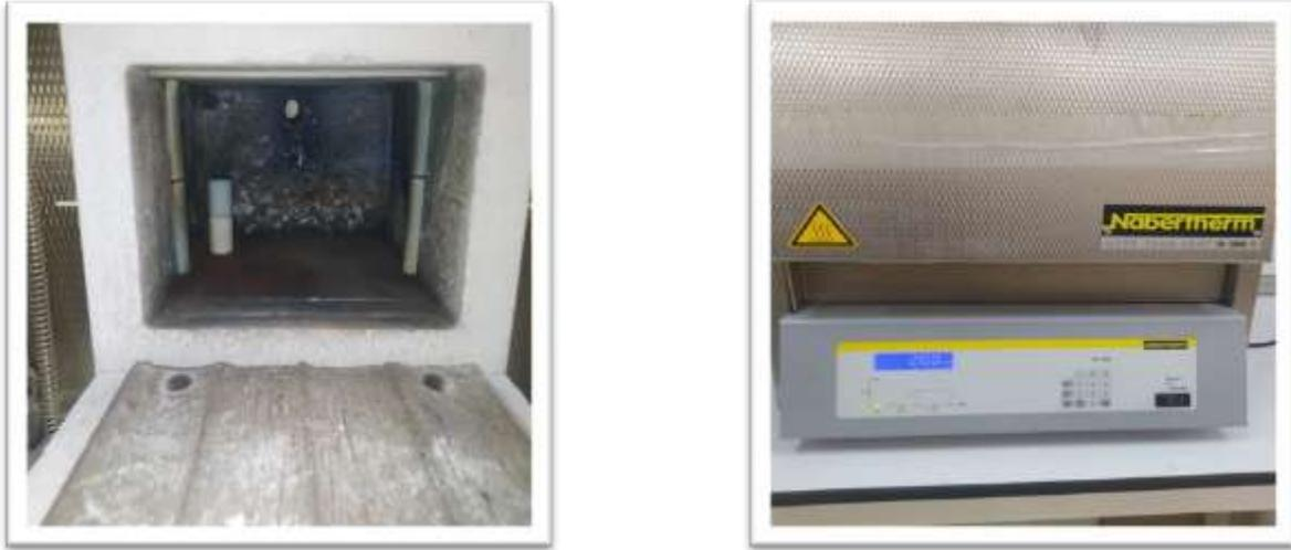
**Figure.III.5 :** Calcination à une vitesse de  $5^{\circ}\text{C}/\text{min}$  jusqu'à  $T = 900^{\circ}\text{C}$ , pendant différentes durées (2 h, 4 h, 6 h)
