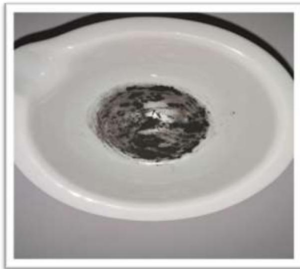
**Figure.III.6 :** la poudre résultant de la calcination
