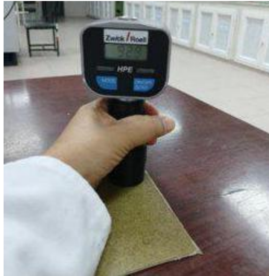
Figure 3.12 - Test de la dureté Shore (Source : Auteur).
