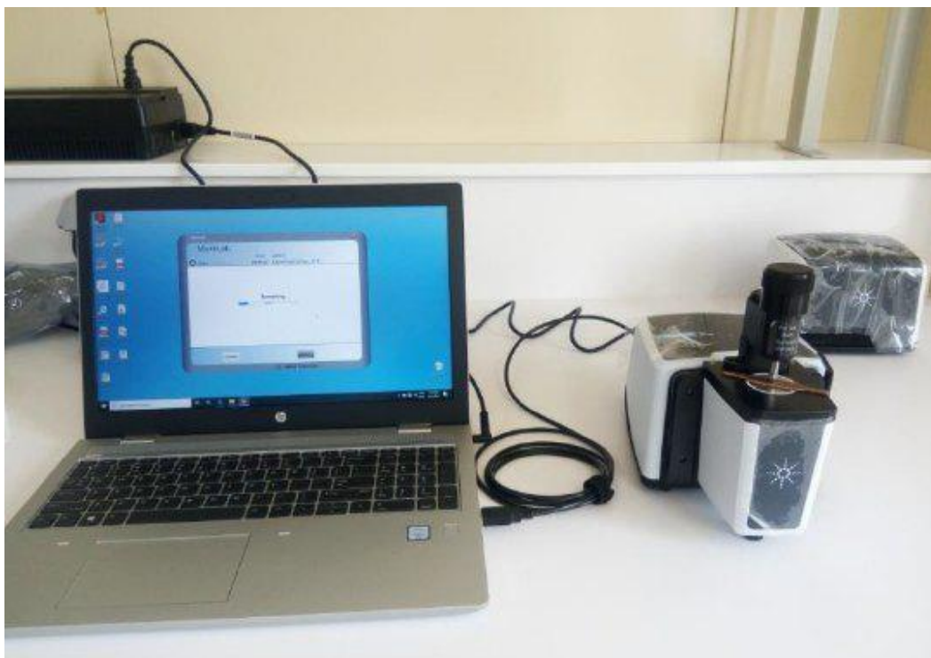
Figure 3.7 - Spectromètre Agilent Cary 630 FTIR (Source : Auteur).
