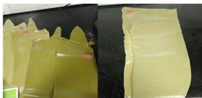
Figure 3.5 - Une bande de PVC vierge obtenue par calandrage (Source : Auteur).
