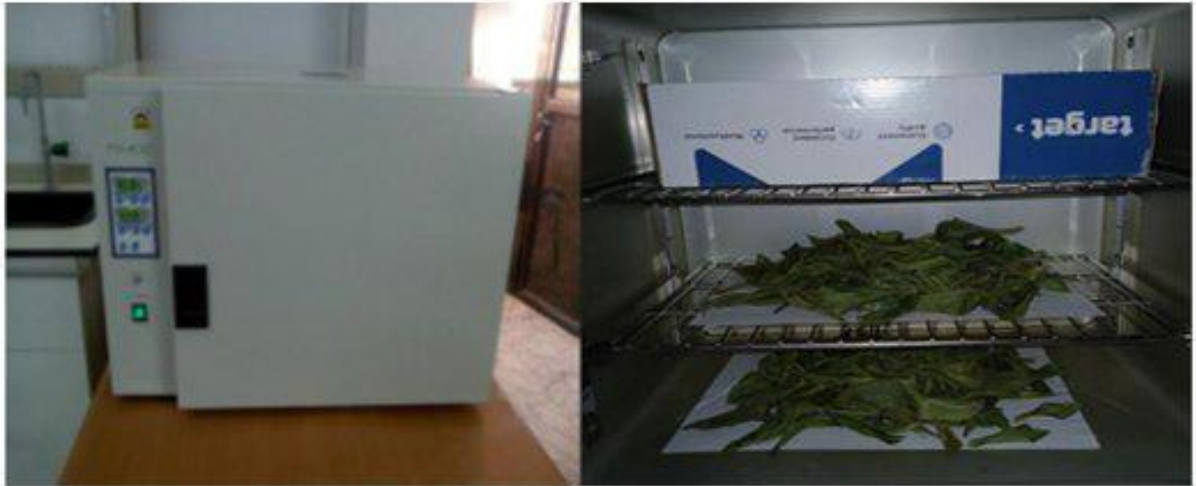
Figure 3.2 - Séchage du FM dans l'étuve à 80 °C (Source : Auteur).
