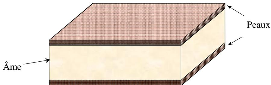
Figure 1.8. Illustration d'une structure sandwich[8].
