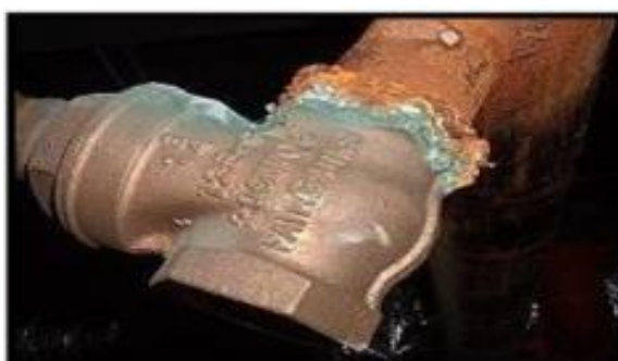
الشكل (3.I) : التآكل الغلفاني [13].
