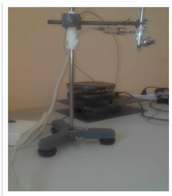
الشكل (III-1): جهاز ترسيب الأغشية الرقيقة بالتحلل الحراري عن طريق الرش بالهواء المضغوط
