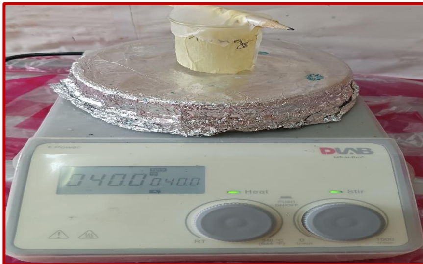
الشكل II.8. دراسة تأثير درجة الحرارة على تآكل العينات في وجود المثبط.
