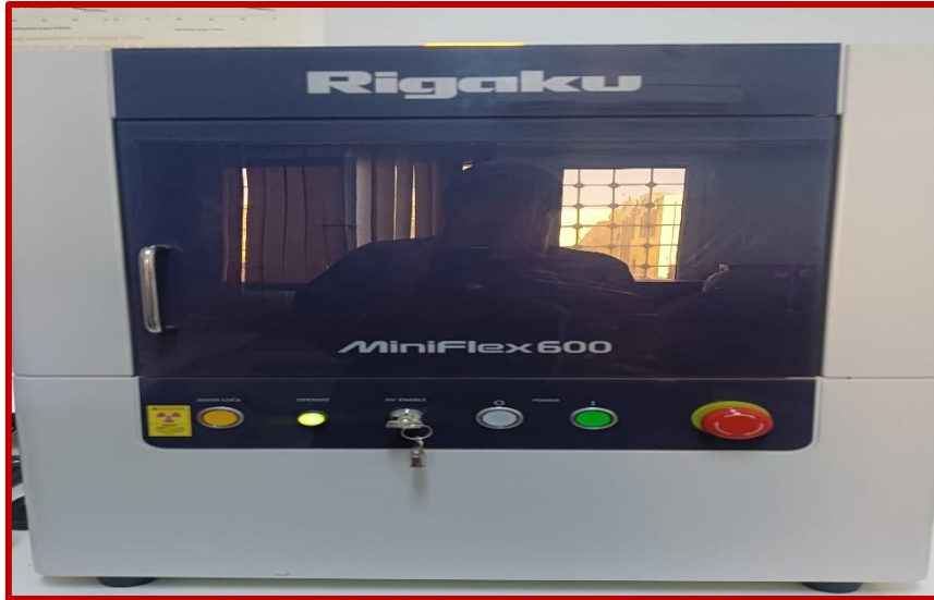
الشكل 9.II. جهاز انعراج الأشعة السينية.
