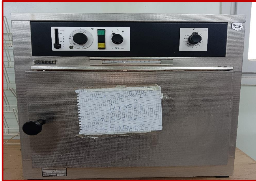
الشكل 5.II. الفرن الكهربائي الحراري.
