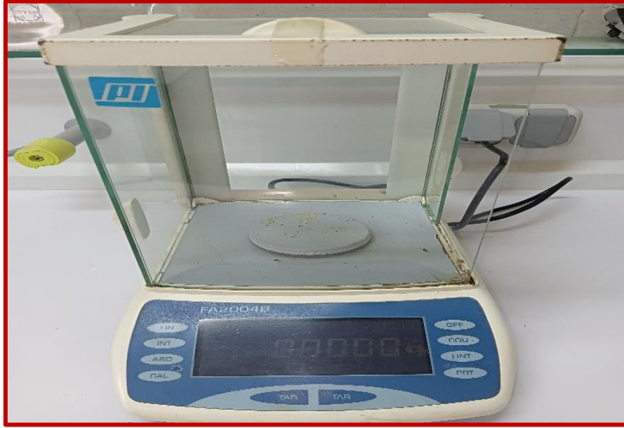
الشكل II.7. صورة فوتوغرافية لميزان الكتروني.
