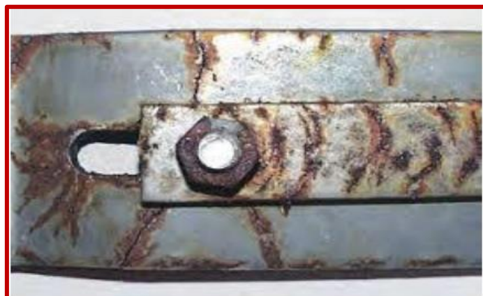
الشكل 4.I. التآكل الشقي [11].
